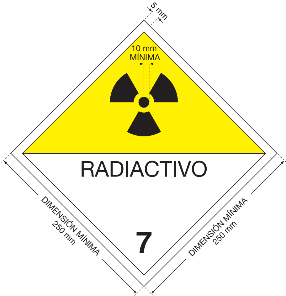
Fig. 6. Rotulado. Salvo en los casos permitidos en virtud del párr. 571, las dimensiones de este modelo son las mínimas; cuando se utilicen rótulos de distintas dimensiones se guardarán las mismas proporciones que en el modelo. El número “7” tendrá una altura no inferior a 25 mm. El color de fondo de la mitad superior del rótulo será amarillo y el de la mitad inferior blanco, el trébol y los caracteres y líneas impresos serán negros. El empleo del término “RADIOACTIVO” en la mitad inferior es facultativo, con el fin de permitir también la utilización de este rótulo para indicar el número apropiado de las Naciones Unidas correspondiente a la remesa.
